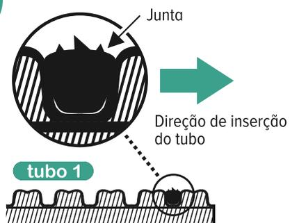
Colocar a junta entre a primeira e a segunda corruga da ponta macho do tubo. Os lábios da junta devem estar na direção de facilitar a introdução do tubo, tal como representado na figura.
