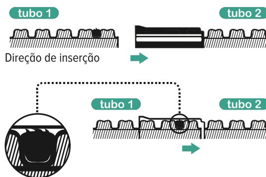
A junta vai ficar perfeitamente selada entre paredes, uma vez bem efetuado o acoplamento dos tubos.
