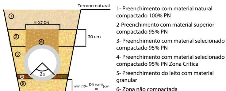
Para o preenchimento de vala devem ser utilizados materiais adequados. Para execução do leito da vala e primeiras camadas deve ser utilizado material de baixa granulometria. Deve ter-se extremo cuidado e rigor na compactação, de modo a assegurar o preenchimento completo das corrugas.
